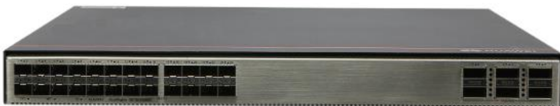
Figura 2 – Switch com interfaces de até 100 Gbps adquiridos para serem implantados no backbone REMEP-FLN
