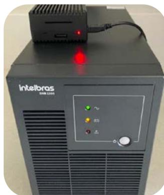
A equipe da REMEP-FLN, então, desenvolveu um módulo de baixo custo para monitoramento de nobreaks. Este *appliance* pode ser adaptado para funcionar com diversas marcas e modelos de equipamentos e tem por objetivo reduzir os custos de implantação do projeto, além de possibilitar a integração com sistemas já existentes dentro das instituições.
